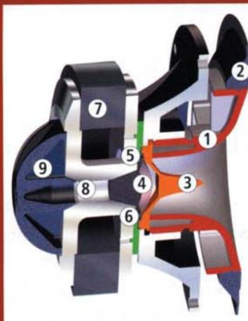
Vue en coupe du tweeter TZ2900. 1 - Pavillon circulaire assurant un parfait couplage avec l'air de la pièce, tout en améliorant le rendement, et en contrôlant parfaitement la linéarité de la pression acoustique. 2 - Anneau de mousse périphérique qui amortit les accidents de bord. 3 - Pièce de mise en phase centrale augmentant la pression de l'air pour la canaliser à l'entrée du pavillon avec un minimum de réflexion interne (augmente dans de grandes
