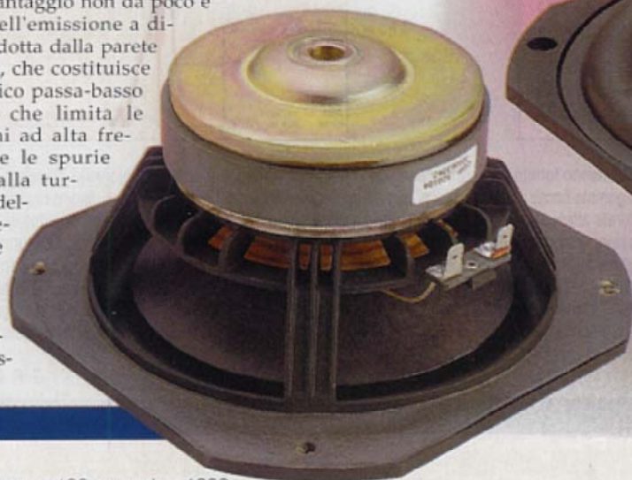
I trasduttori sono stati progettati e realizzati dallo stesso costruttore. Notare il tweeter dalla cupola di 38 millimetri ed il woofer col cestello pressofuso dotato di ampie feritoie di ventilazione.
