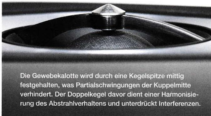
Die Gewebekalotte wird durch eine Kegelspitze mittig festgehalten, was Partialschwingungen der Kuppelmitte verhindert. Der Doppelkegel davor dient einer Harmonisierung des Abstrahlverhaltens und unterdrückt Interferenzen.
