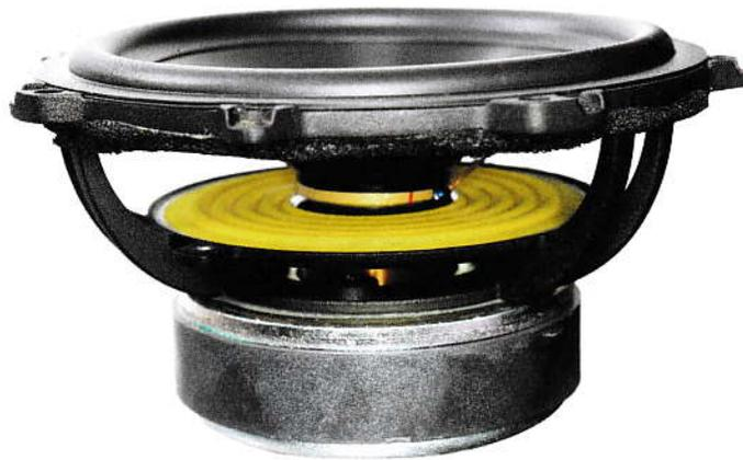
Der Tieftöner kombiniert einen sehr kleinen Schwingspulen-durchmesser mit Überhang-Wicklung und kurzem Magnetspalt. Die großzügige Hinterlüftung der Zentrierung verhindert Kompressionsneigung auch bei großen Hübten.
