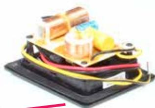
Componenti del filtro, di ottima qualità, sono saldati su un PCB a ridosso della vaschetta dei contatti
