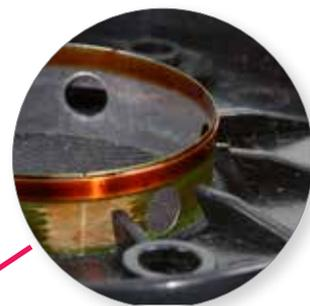
Il supporto dell'equipaggio mobile è scostato dal magnete per favorire il flusso dell'aria attraverso e tramite la compressione dietro la membrana
