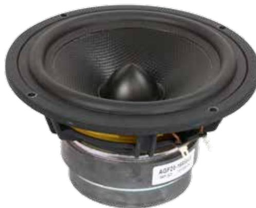
**Il cestello del nuovo woofer è in pressofusione con un disegno aerodinamico e senza impedimenti all'emissione posteriore della membrana in polipropilene sagomato e termoformato tramite la particolare tecnica di tessitura e tramatura di sottili fili; vengono parzialmente fusi insieme dopo essere adagiati sullo stampo.**
