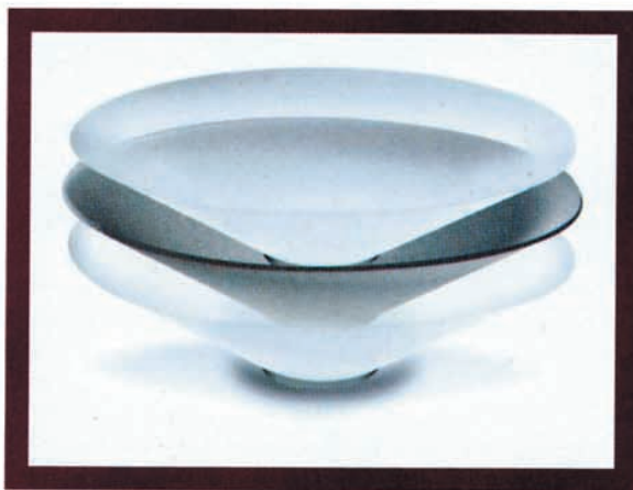
Vue éclatée de la membrane « W » avec les très minces feuilles de verre tressé, de part et d'autre du cône en mousse structurelle.
