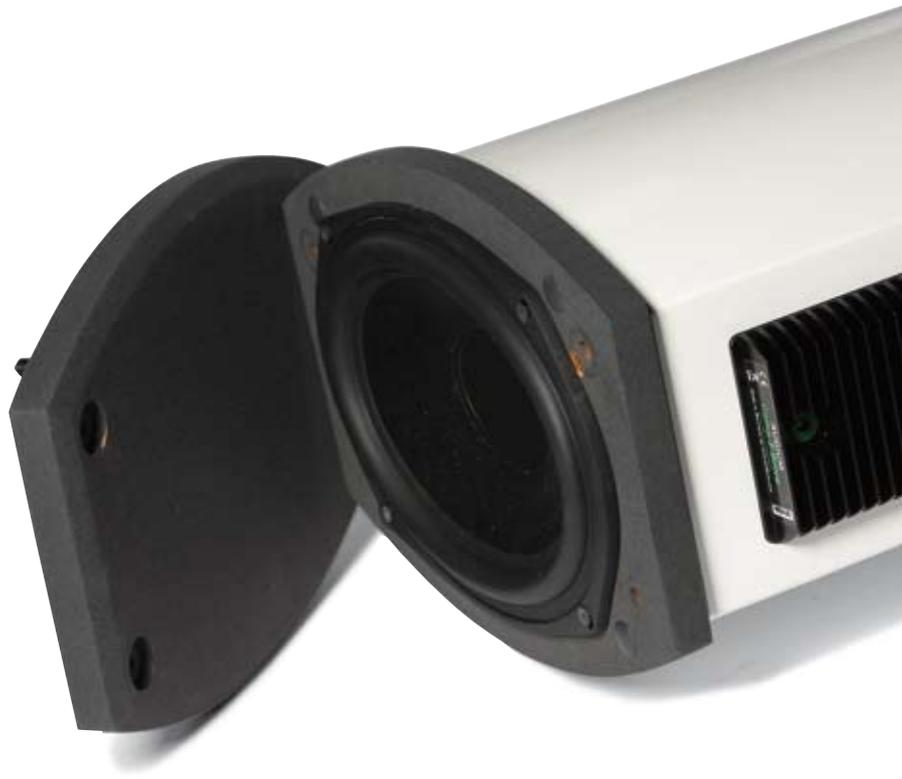
**DAS GEHT SO TIEF:** Der ovale Basstreiber arbeitet per Downfiring auf eine mit Abstand verschraubte Bodenplatte, um eine definierte Bassabstrahlung zu ermöglichen. Das Reflexrohr im hinteren Teil der Box unterstützt nur unter 60 Hz.
