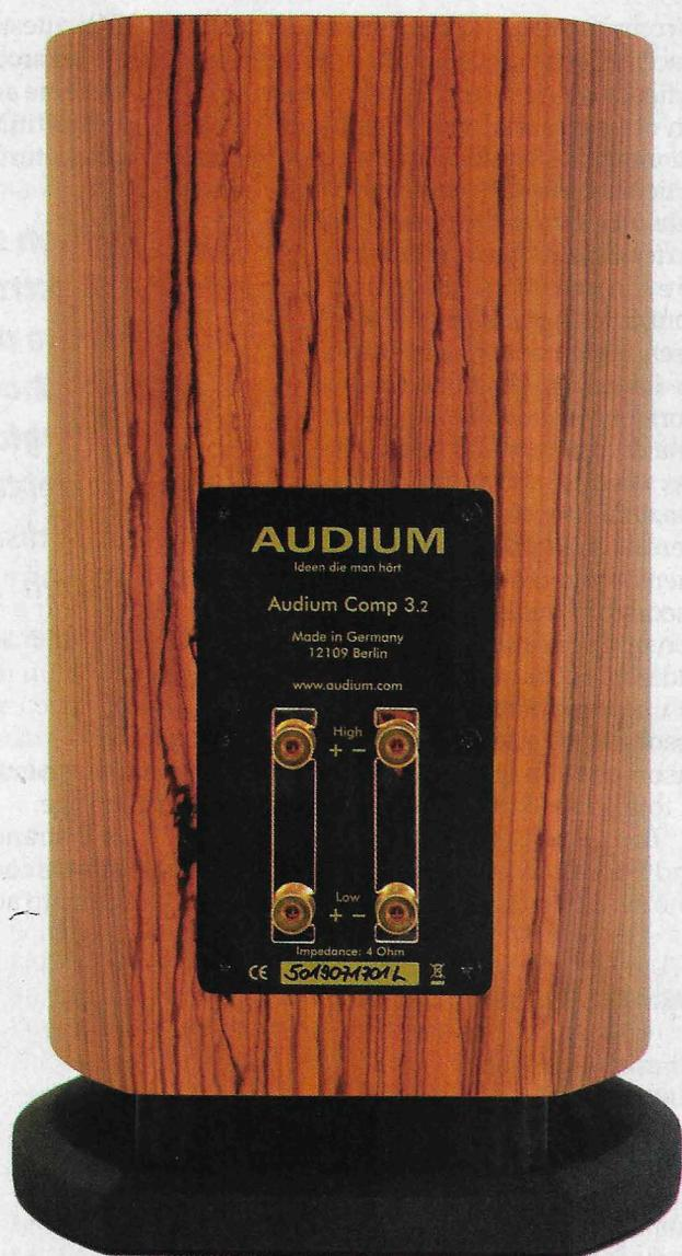
I binding post di potenza sono di ottima fattura, placcati oro, in configurazione bi-wire, i ponticelli sono laminari. Il crossover è davvero minimale e costituito da componentistica di alta qualità come i condensatori MKT e MKP di Wima e Wego, le sezioni dedicate al fullrange e al woofer sono montate su differenti PCB realizzate appositamente, separate e disaccoppiate tra loro. L'architettura interna del mobile presenta degli irrigidimenti, il materiale è il classico MDF.
