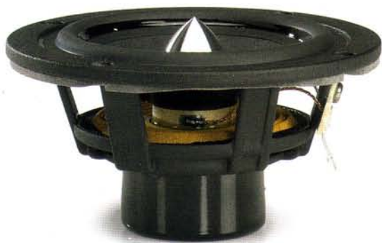
Breitbandchassis 2009: Mit Neodym-Magnet, Phasenkegel und Bambus-Papierfasermembran ist der kleine Dreizöller ein echtes Hightech-Teil
