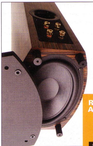
**KELLER-BASS:** Das ovale Chassis sitzt im Sockel der Box und arbeitet via Grenzflächeneffekt bis in den Grundtonbereich hinauf. Ganz unten wird es durch ein Reflexrohr verstärkt.
