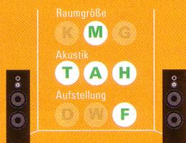
Parallel zur Wand oder leicht einwinkeln (in trockenen Räumen stärker), nach hinten neigen. Geht auch wandnah mit etwas fetterem Tiefbass.
