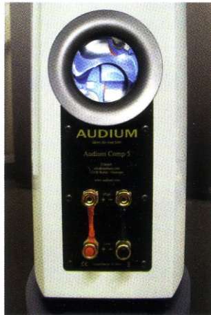
In der Bassreflexöffnung oberhalb des Bi-Wiring-Terminals spiegelt sich wunderbar die Frequenzweiche.
