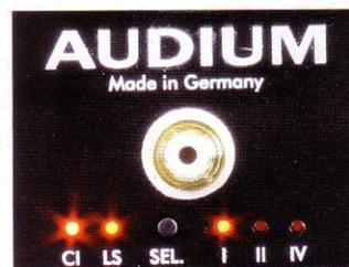
Musiksignale werden analog per Cinch zugeführt. Per LED-Reihe lässt sich die Konfiguration prüfen.
