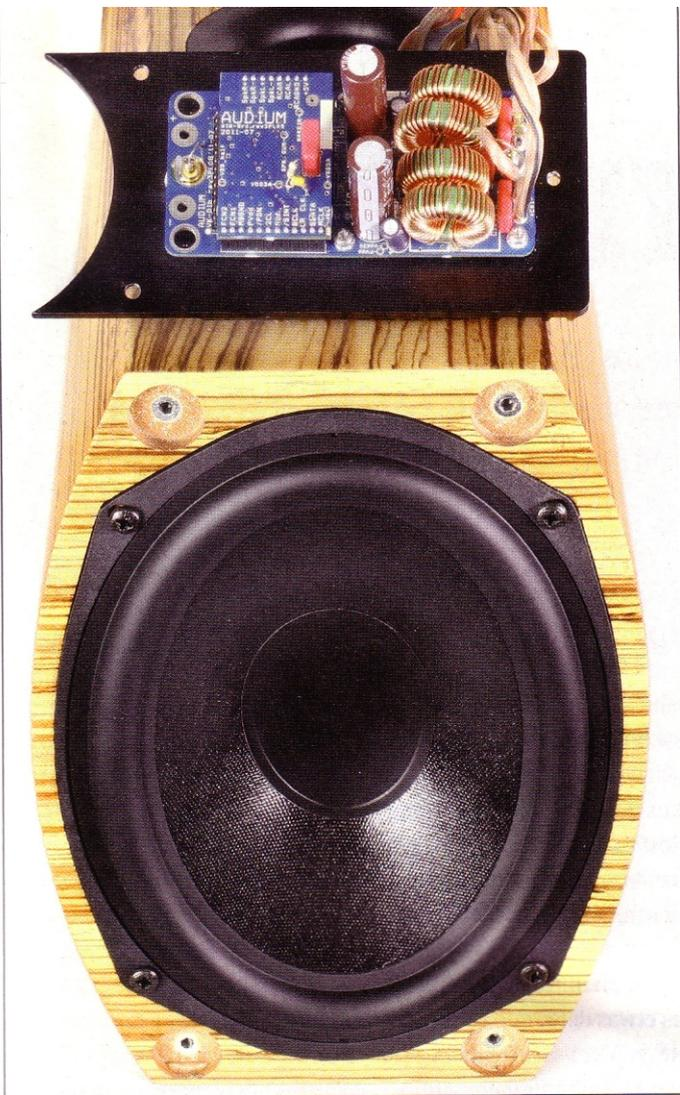
Wenig, aber kostbar: Auf den zwei hausintern entwickelten Platinen sitzen die DSP-Weiche und die Schaltverstärkerkanäle. Der Bass mit seiner massiven Sicke ist oval geformt.
