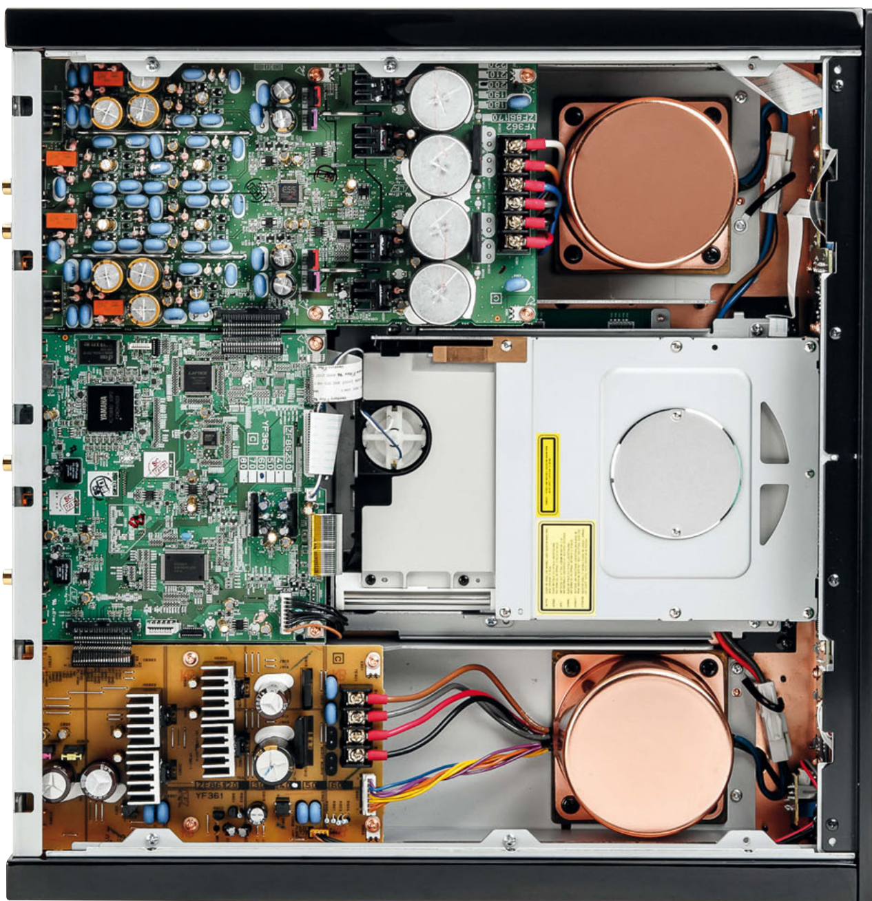
L'interno del CD-S3000 permette di individuare tre distinte zone: al centro la pregevole meccanica ed i circuiti di controllo e ai due lati le sezioni analogica e digitale, ognuna delle quali dotata di propria sezione di alimentazione indipendente.
