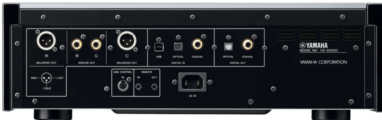
Il retro del CD-S3000, anch'esso contraddistinto dai connettori per l'uscita del segnale bilanciato. Da notare gli ingressi che impiegano il convertitore interno, USB, digitale ottico e coassiale.
