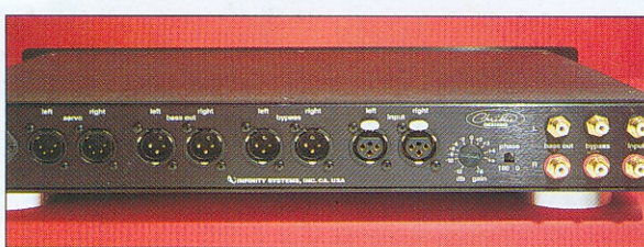
Le connessioni duplicate in bilanciato e sbilanciato, sul pannello posteriore dello SCU.
