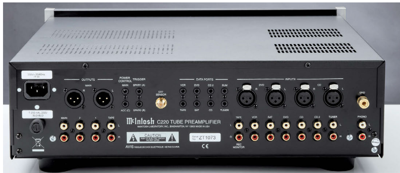
C220, vista pannello posteriore; numerose le prese a disposizione.
