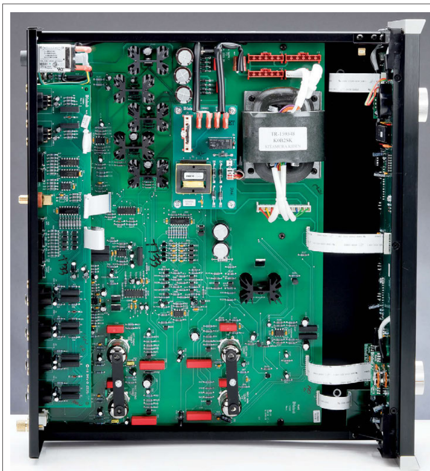
C220, vista dell'interno; ottima ingegnerizzazione con poco cablaggio.
