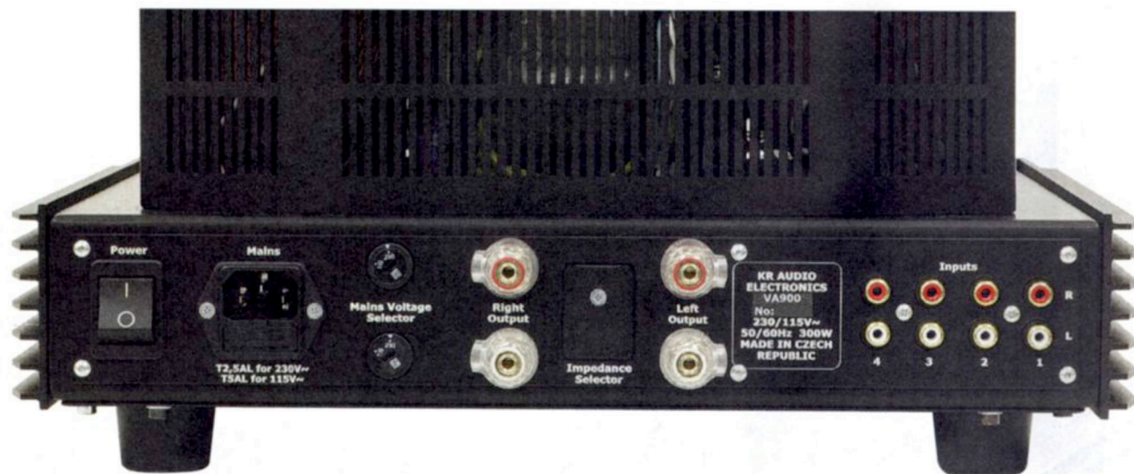
Il pannello posteriore ospita tutte le connessioni, i fusibili e l'interruttore generale; da notare tra le boccole dei cavi di potenza il piccolo scompartimento dove si trova l'originale sistema d'impostazione dell'impedenza di uscita.
