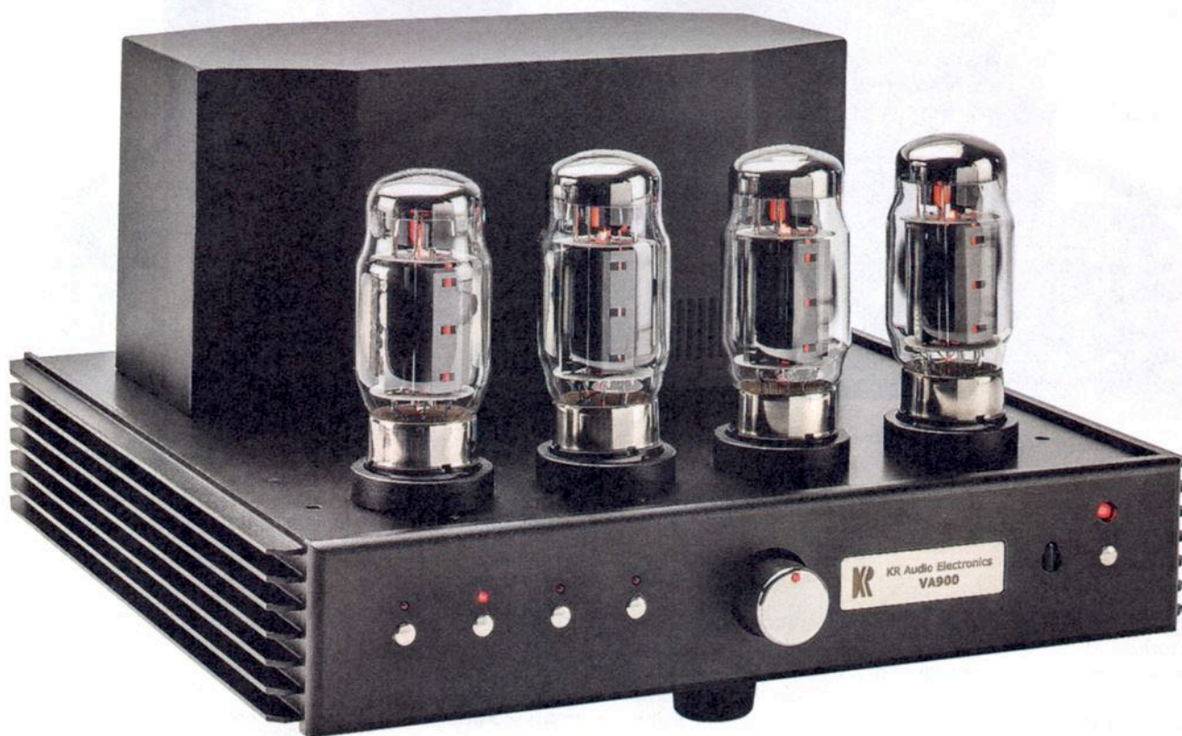
Rimossa (facilmente) la griglia di protezione, l'amplificatore mette orgogliosamente in mostra le quattro KT120 di potenza. Mancano invece le valvole di segnale, stante il particolare circuito che adotta componenti a stato solido.
