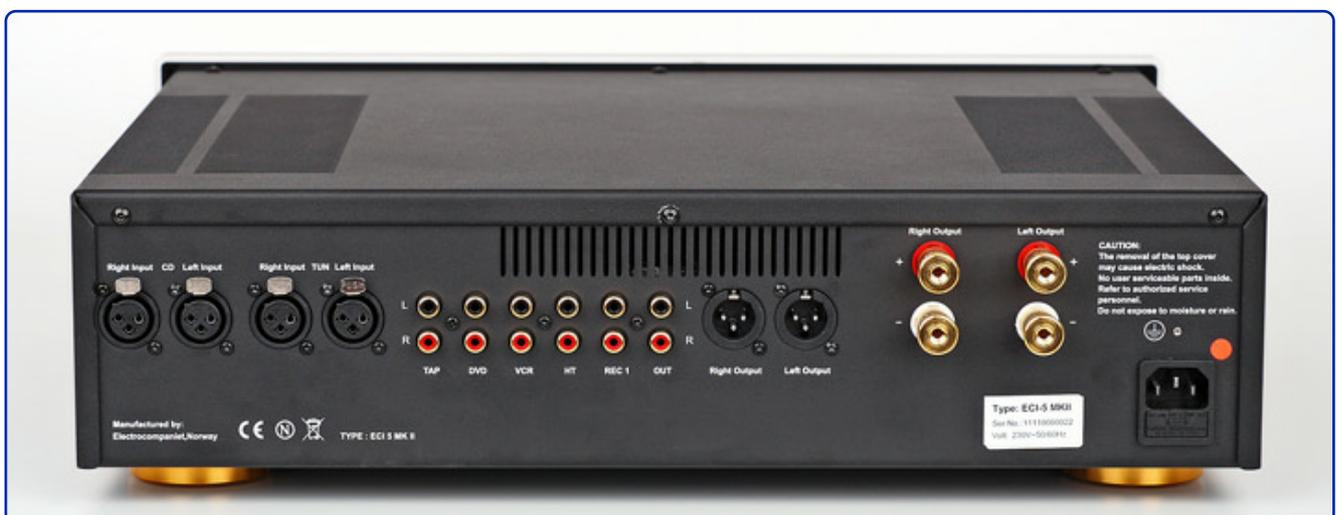
Neben den zwei symmetrischen stehen drei Paar Cincheingänge zur Verfügung. Bei Bedarf kann der ECI 5 MKII auch in eine Mehrkanalanlage (Eingang HT) integriert werden. So unscheinbar der rote Punkt am Netzeingang wirkt, seine Aufgabe ist wichtig: Auf dieser Anschlussseite sollte Phase anliegen.
