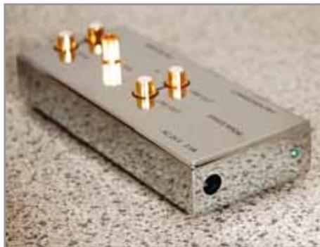
Vista laterale del PP1 che mostra i due pin di ingresso, i due pin di uscita e in mezzo, il connettore di terra. Sul fianco laterale il foro che accetta il cavetto di alimentazione.
