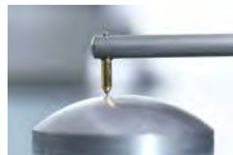
Come nasce una cupola in diamante. Sopra: ogni cupola viene rifinita mediante laser per rimuovere ogni irregolarità superficiale e quindi misurata per la massima uniformità. A destra: un gruppo di cupole ultimate con il loro rivestimento protettivo in platino.
