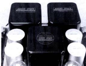
▲本体後部には巨大なトランスが3個配置されている。左奥がパワーサブライ、右奥がチョークコイル、そして手前にはアウトプット・トランスフォーマーと記されている。
