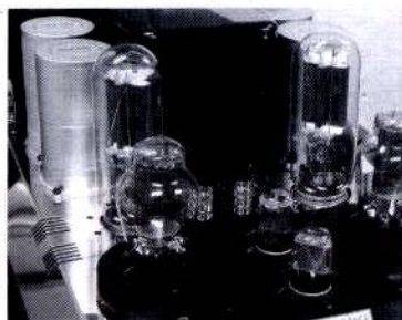
▲奥にあるのが直熱3極管「845」、その手前が名球として知られる「300B」。その300Bが845のドライバーとして使われているのである。中央部の真空管はGT型双三極管6SN7だ。
